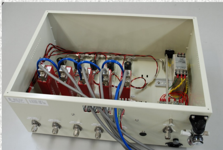
マスフローコントローラと電磁弁をBOXに組み入れた例
